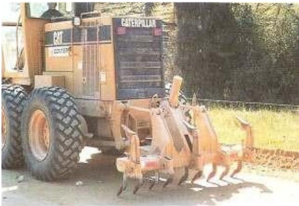
Figura 43: escarificador localizado na traseira da motoniveladora (Fonte: Baesso e Gonçalves, 2003)
