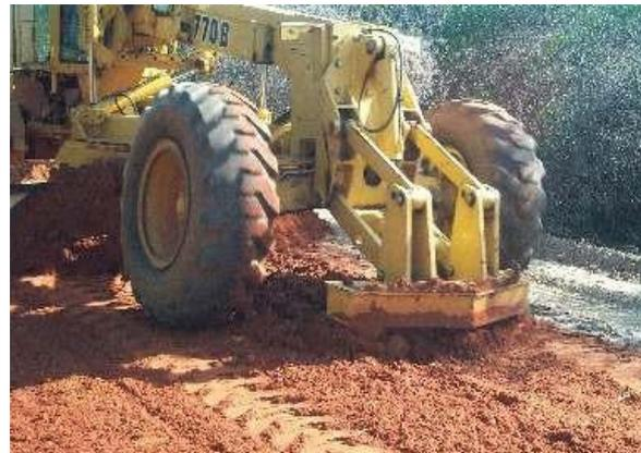
Figura 44: escarificador em ação (Fonte: Baesso e Gonçalves, 2003)
