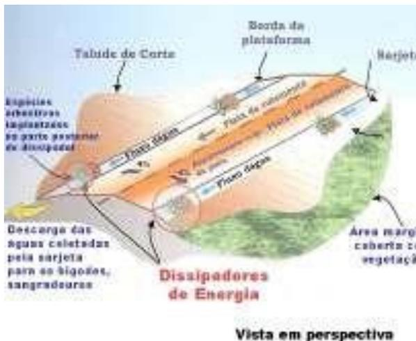
Figura 27: demonstração de dissipadores de energia (Fonte: Baesso e Gonçalves, 2003)
