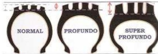
Figura 45: especificação de sulcos nos pneus
