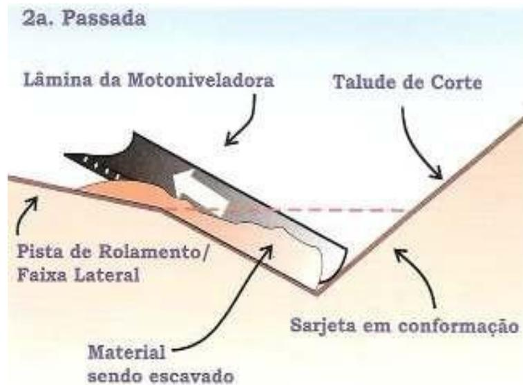
Figura 19: a segunda passada da motoniveladora remove o solo depositado no fundo da valeta, promovendo a regularização da sarjeta (Fonte: Baesso e Gonçalves, 2003)
