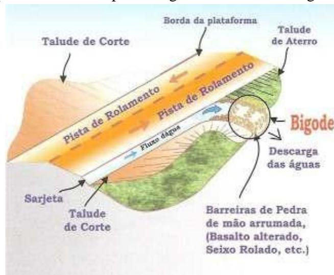
Figura 21: demonstração de como deve estar postado o bigode na estrada. E a presença de pedras no trajeto da água, o que facilita a dissipação de energia da mesma (Fonte: Baesso e Gonçalves, 2003)
