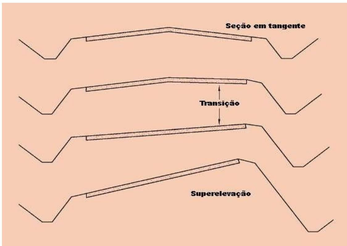
Figura 10: transição de uma seção tangente até alcançar a superelevação (Fonte: Ken Skorseth, 2000)
