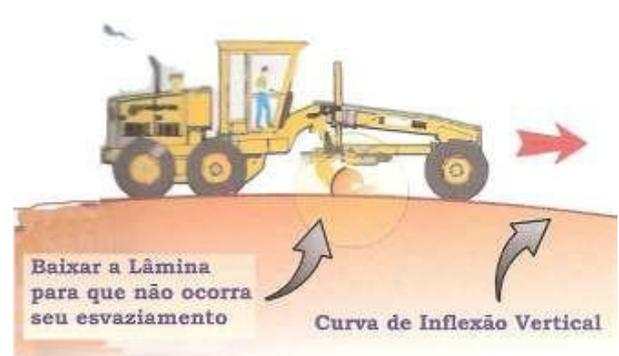
Figura 54: operação da motoniveladora em curva convexa (Fonte: Baesso e Gonçalves, 2003)
