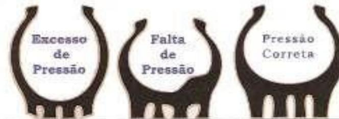
Figura 46: pressões internas nos pneus de motoniveladoras
