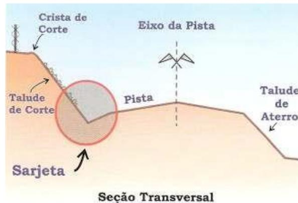
Figura 15: localização da sarjeta em uma seção transversal (Fonte: Baesso e Gonçalves, 2003)
