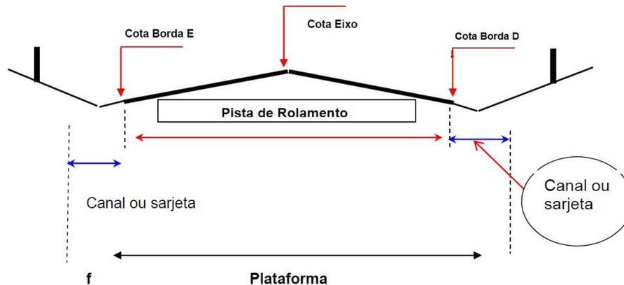
As diferenças identificadas são as diferenças entre as leituras: (Cota EIXO – Cota da Borda da Pista de Rolamento Esquerda) e (Cota EIXO – Cota Borda da Pista de Rolamento Direita) verificadas, das indicadas pelo abaulamento proposto.
