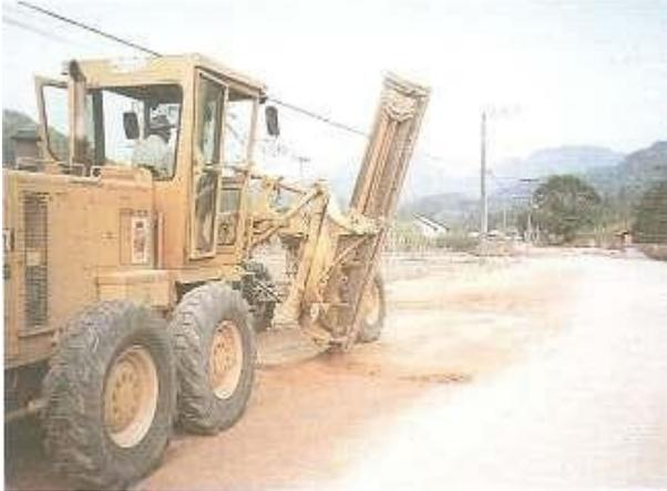
Figura 55: posição da lâmina para espalhamento
