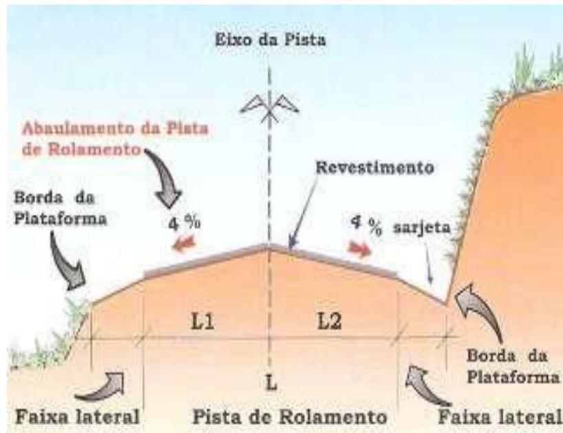
Figura 31: aspecto ideal da plataforma para receber a camada de revestimento (Fonte: Baesso e Gonçalves, 2003)
