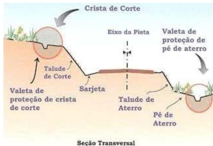
Figura 29: localização de valetas de proteção em uma seção transversal
