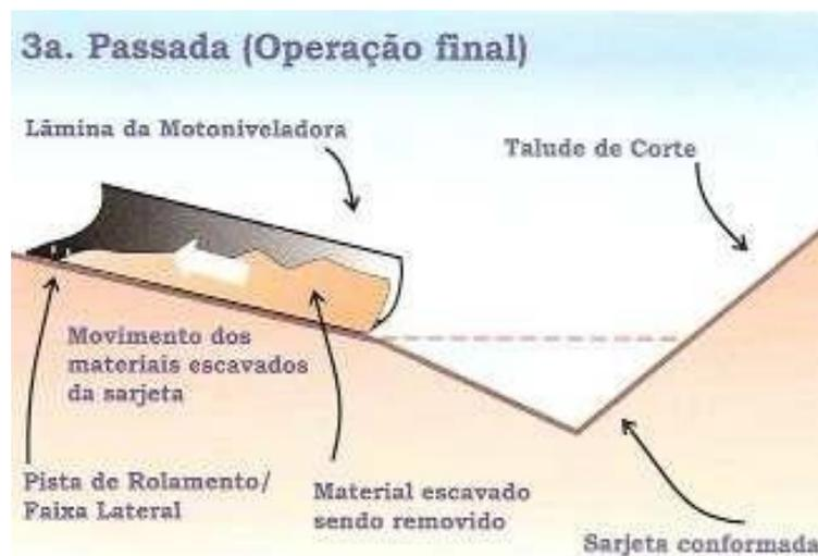
Figura 20: a terceira e última passada da motoniveladora remove todos os materiais da sarjeta que se acumularam durante o processo (Fonte: Baesso e Gonçalves, 2003)
