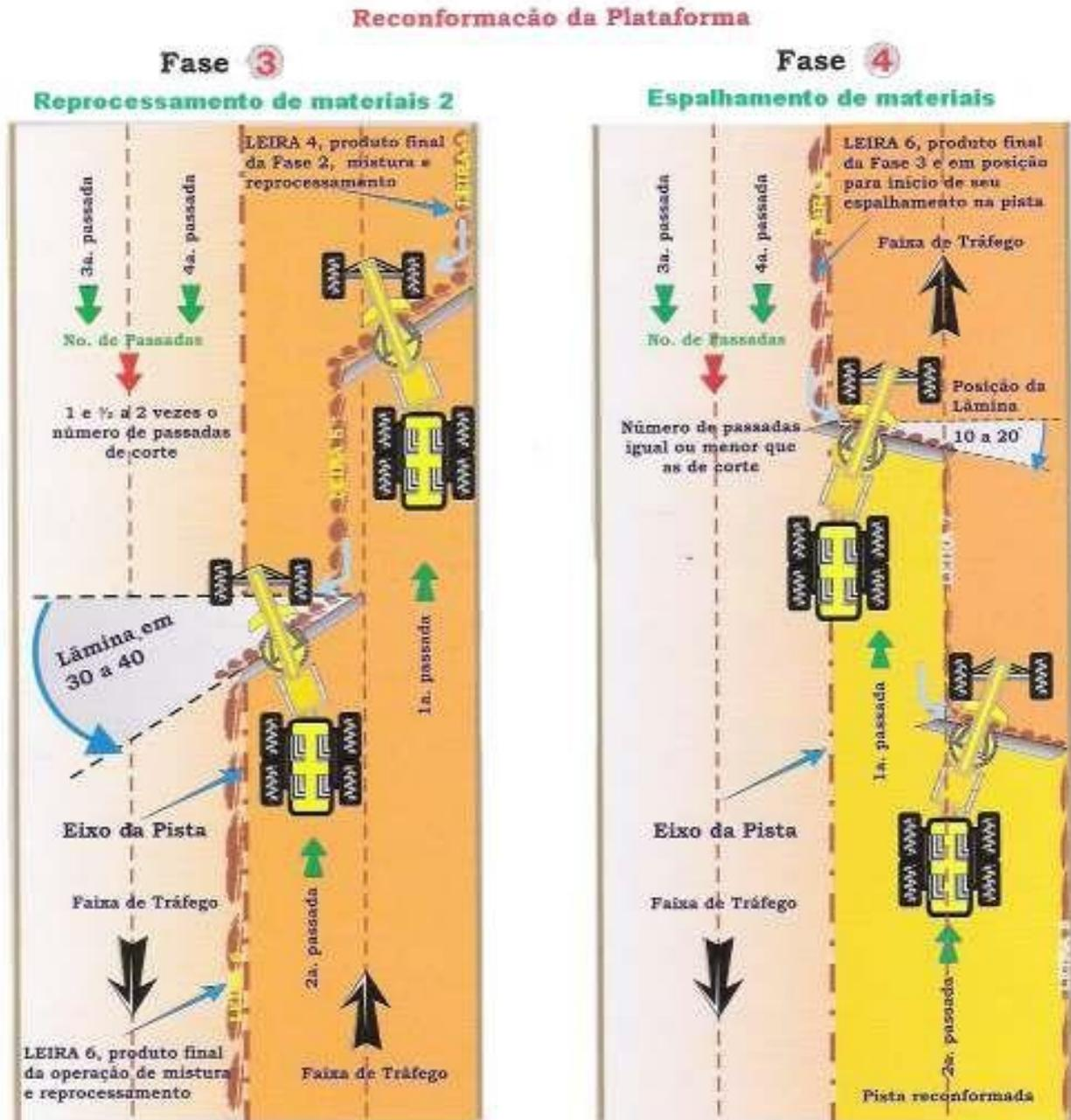
Figura 59: fase 3 e 4 do processo de regularização do pavimento
