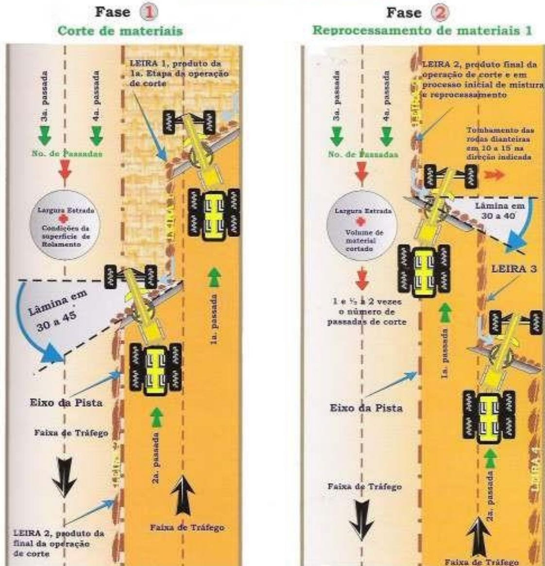
Figura 58: fase 1 e 2 do processo de regularização do pavimento
