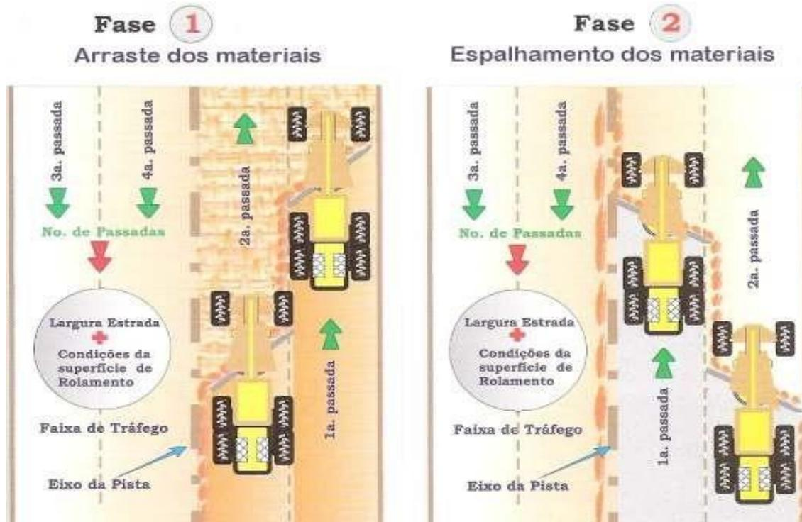
Figura 57: fase 1 e 2 do processo de regularização do pavimento (Fonte: Baesso e Gonçalves, 2003)
