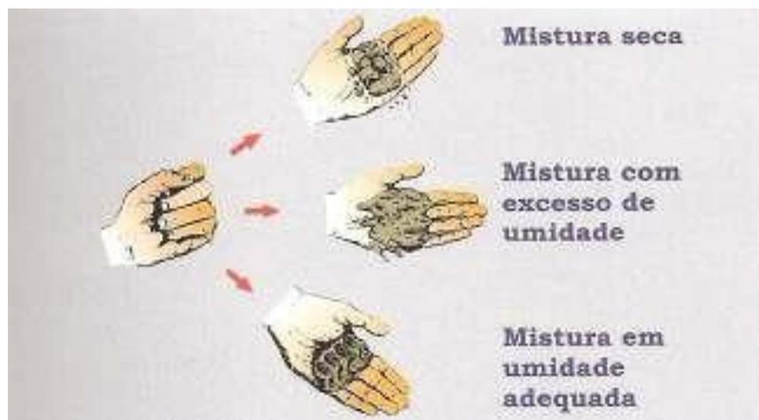
Figura 37: teste expedito que deve ser realizado no campo, para verificação do teor de umidade do material
