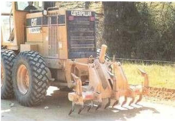
Figura 43: escafricador localizado na traseira da motoniveladora (Fonte: Baesso e Gonçalves, 2003)
