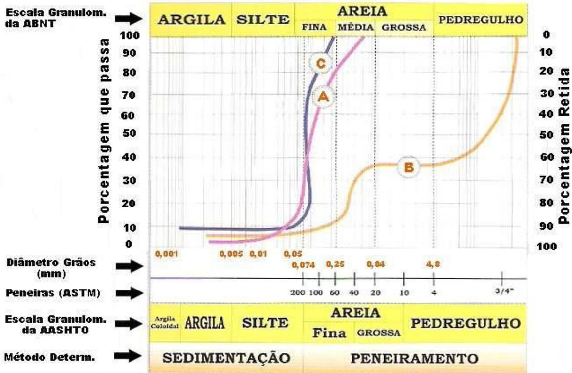
Segundo a figura 13, é mostrado os resultados de três ensaios granulométricos. Podemos verificar que a curva A apresenta uma granulometria “contínua”, a curva B “descontínua”, já a C apresenta uma granulometria “bem graduada”.
