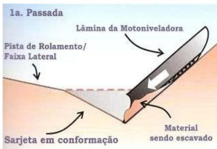
Figura 18: a regularização inicia-se pela face oposta da sarjeta, para alcançar a profundidade desejada e regularizar um lado da sarjeta (Fonte: Baesso e Gonçalves, 2003)
