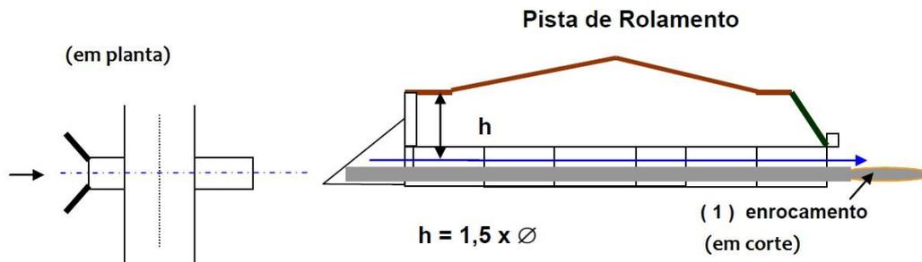
**15.2.2.** Muros de Ala e caixas de captação para tubulações: em alvenaria de tijolos comuns, e estrutura de concreto armado, conforme detalhe em projeto.
