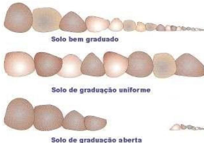
Na maioria dos casos, as proporções de agregados encontrados em jazidas não são adequadas, tornando-se necessário a estabilização granulométrica desses materiais com a adição dos agregados ausentes. O objetivo é manter a mistura estável para utilização em campo com uma boa graduação como foi visto no item sobre classificação dos materiais.
