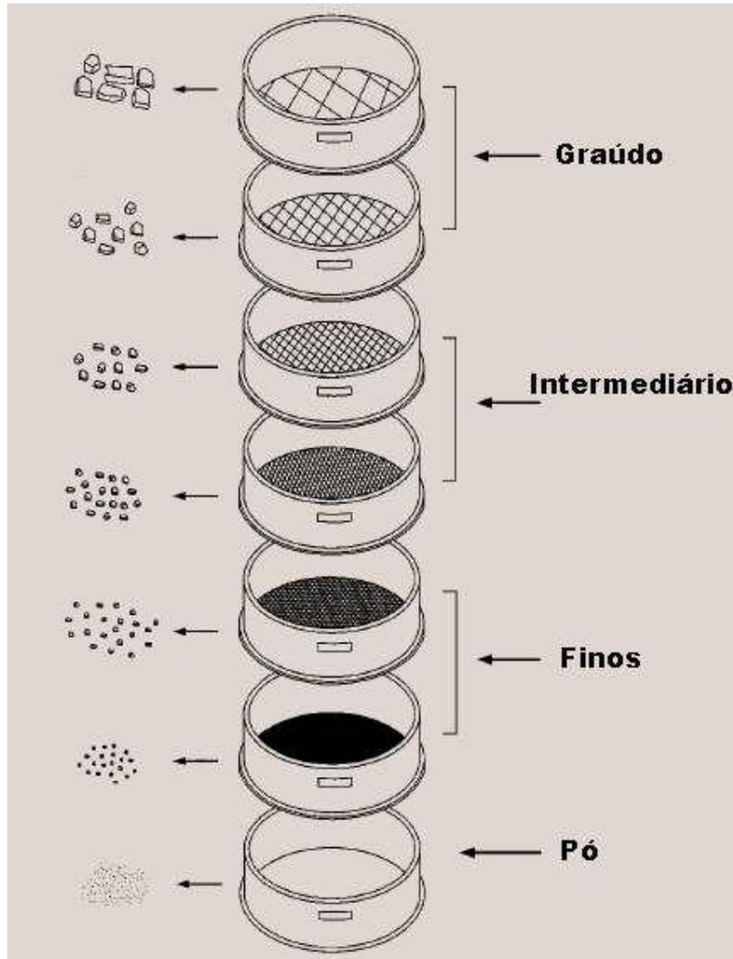
Figura 12: ensaio de peneiramento (Fonte: Ken Skorseth, 2000)
