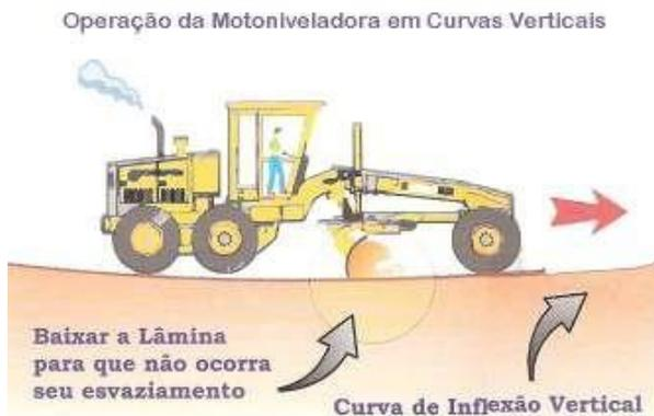
Figura 53: operação da motoniveladora em curva côncava (Fonte: Baesso e Gonçalves, 2003)
